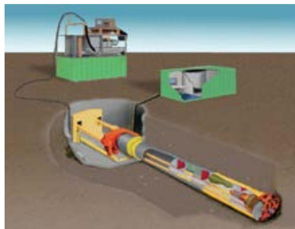
Con l'avanzamento della fresa il materiale di scavo è frantumato fino a dimensioni tali da poter essere
